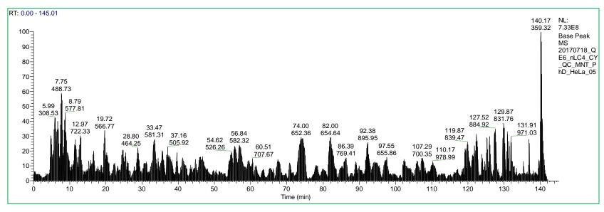
Control 1.9 um ReproSil-Pur 120 C18-AQ beads vs 1 um Exsil Pure 120A RP18 beads
